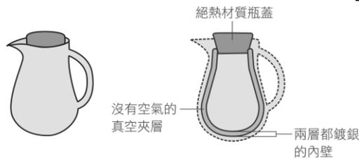
(A)真空夾層可防止熱的傳導與對流 (B)內壁鍍銀是防止熱輻射的方法 (C)絕熱材質的瓶蓋可使熱不易因傳導而散失 (D)保溫瓶不適合保存低溫的冰水。
